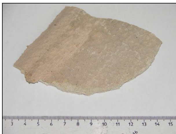
Foto 69: Deska na bázi cementu Plech na podlaze 1.NP Přítomnost azbestových vláken: pozitivní
