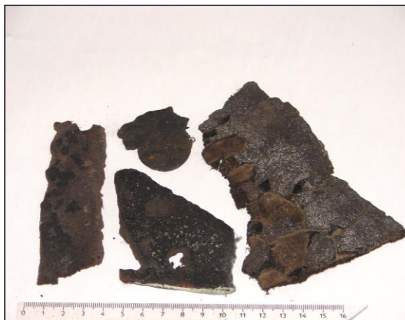
Foto 28: Asfaltová lepenka Střecha přístavku Přítomnost azbestu jako plniva: negativní
