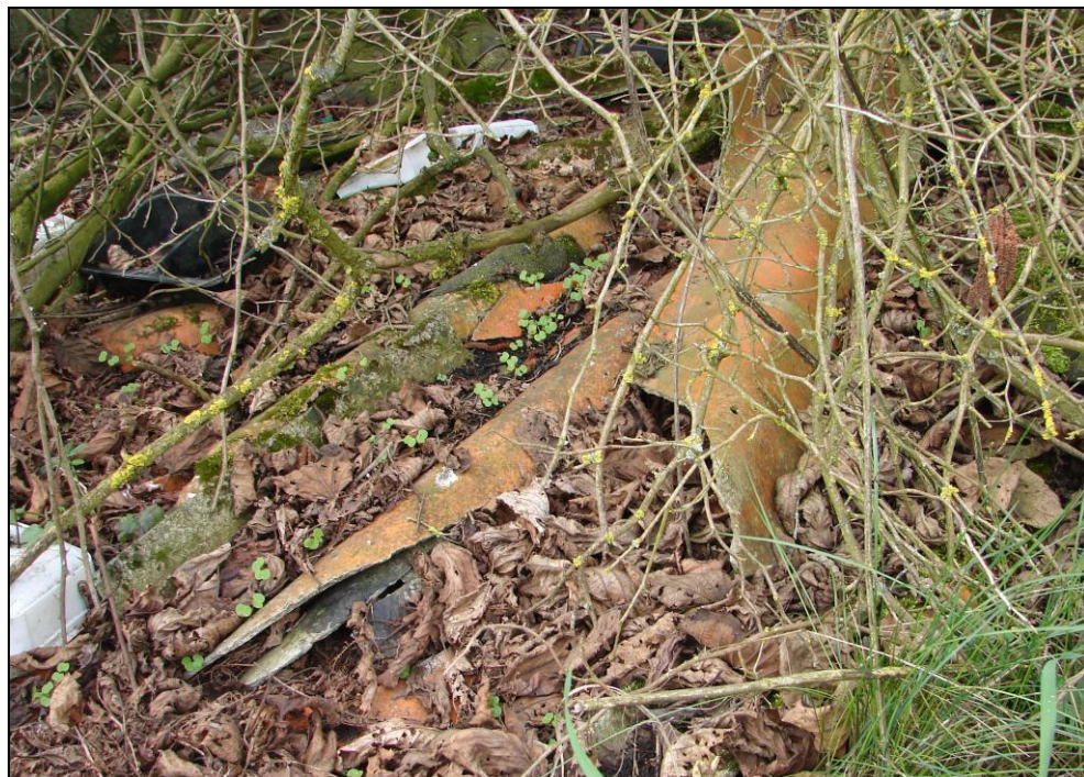
Foto 26: SO 09-45-01 výhybna Straky, přístřešek; okolí přístřešku, vlnité desky na bázi cementu vpravo od přístřešku při pohledu od trati (desky opatřeny oranžovým nátěrem), vlnité desky na bázi cementu obsahují azbestová vlákna
