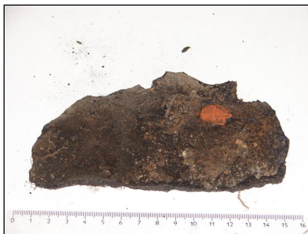
Foto 29: Asfaltová lepenka Spodní izolace Přítomnost azbestu jako plniva: negativní
