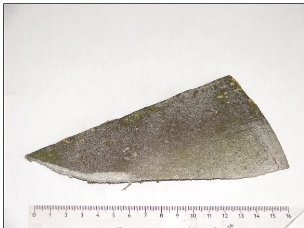
Foto 27: Vlnitá střešní deska na bázi cementu Střecha přístřešku Přítomnost azbestových vláken: pozitivní
